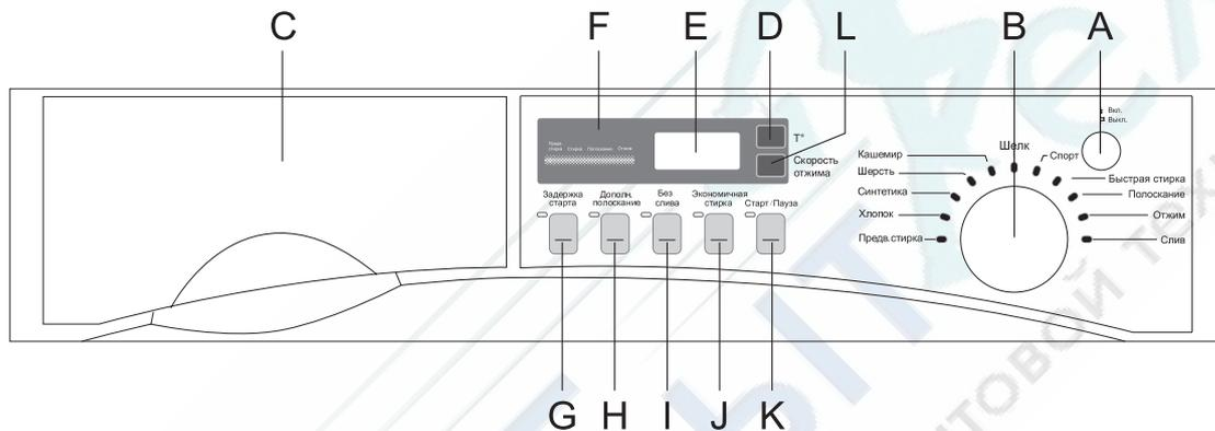
A — кнопка включения или выключения стиральной машины.
